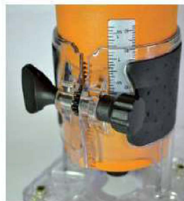
Ajuste micrométrico de la profundidad de fresado.
